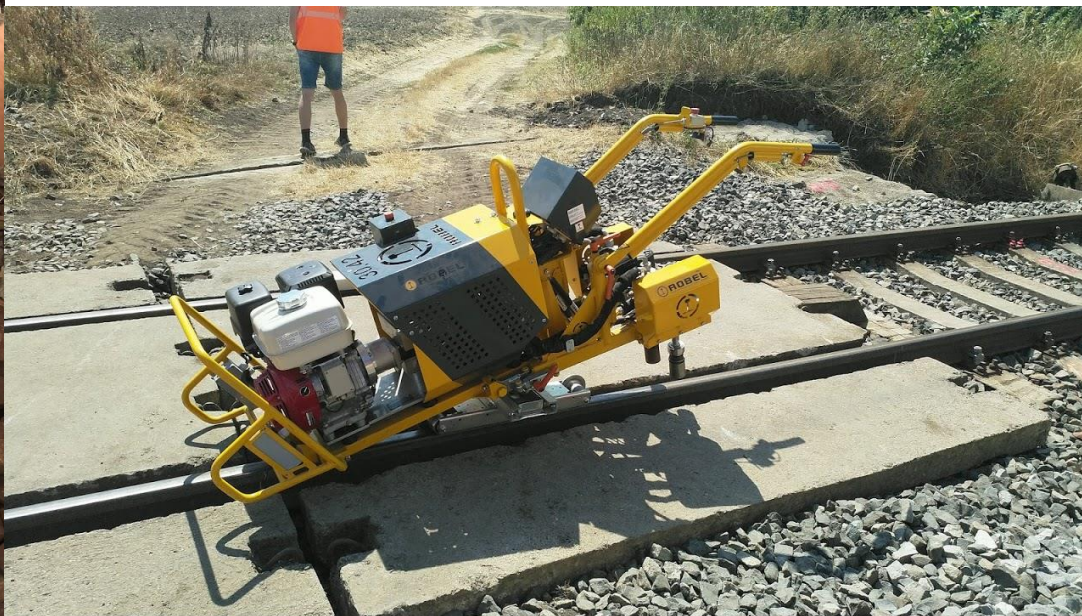
Momentový klíč (Stahwille, zatačečka Robel 30.42 s digitálním záznamem momentu utažení
