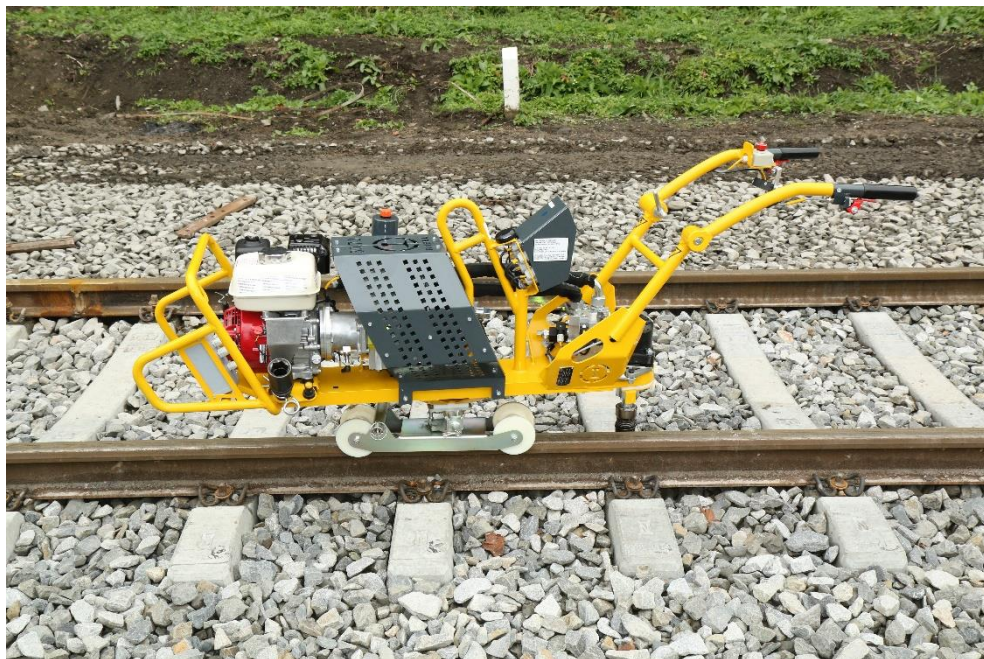
Zatáčečka Robel 30.73 s digitálním záznamem momentu utažení
