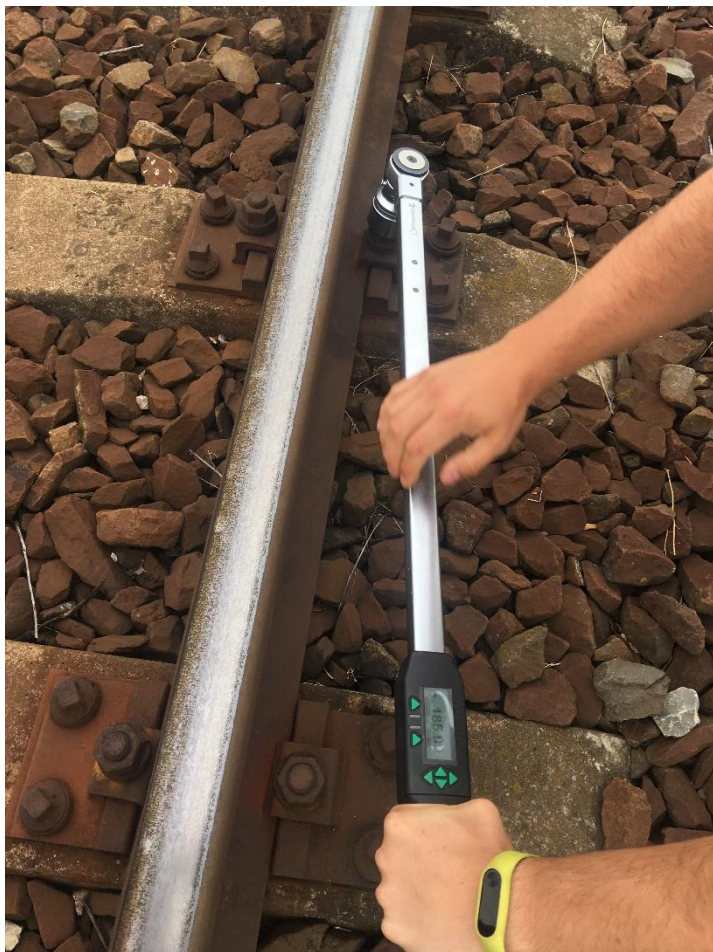
Momentový klíč (Stahwille, zatačečka Robel 30.42 s digitálním záznamem momentu utažení
