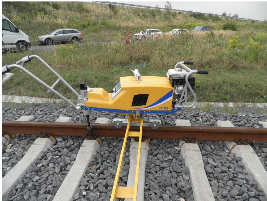
Zatáčečka Geismar TDH 2 s digitálním záznamem momentu utažení
