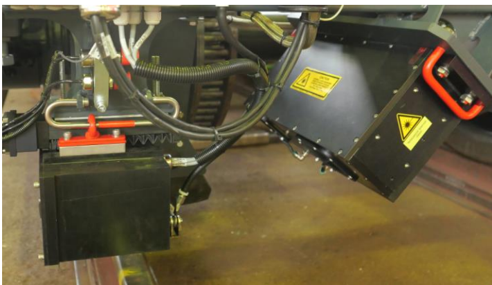
MVŽSv2 – měřicí podvozek a měřicí zařízení ORIAN (USA), GPK a příčný profil kolejnic
