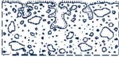
Obrázek 1 – Schematický nákres typické hydrofobní impregnace
